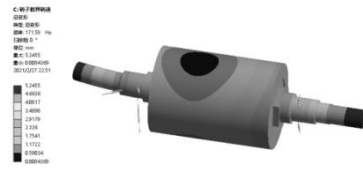
图 18 转子临界转速反向振型图
