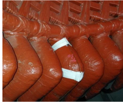
图7 光纤传感器的绑扎固定
