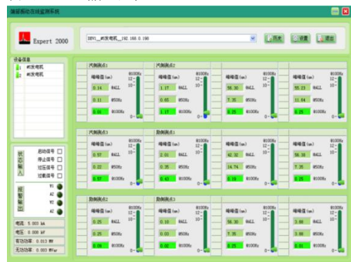
图5 某电厂端部振动实时显示画面
