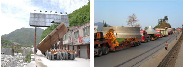
图1 国内某电站水轮机转轮上冠下环运输
